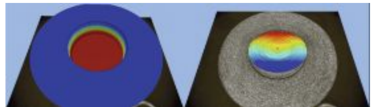
Bild 1: Auch tief liegende Flächen können erreicht und charakterisiert werden, zum Beispiel die Innenfläche eines Werkstücks (links: Gesamtmessergebnis; rechts: Detaildarstellung der tief liegenden Fläche).
